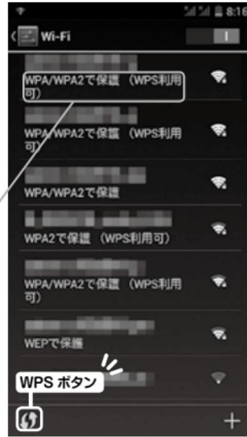
本製品が WPS の接続を開始します。接続したい無線 LAN のネットワーク接続機器（無線 LAN ルーターなど）の WPS ボタンを押してください。WPS 接続が成功すると右図のメッセージが表示され接続設定は完了します。「OK」をタップすると接続設定が保存され次回以降は自動で接続されます。
