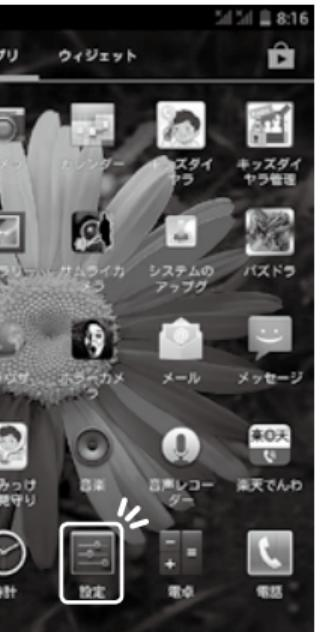
「設定」画面が表示されたら、「Wi-Fi」をタップして「ON」に切り替えます。
